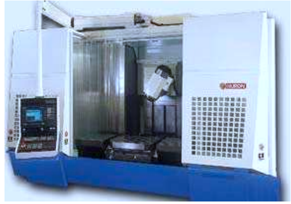
Figure I-6 : Centre d'usinage 5 axes à tête rotative 1 axe et plateau tournant.
