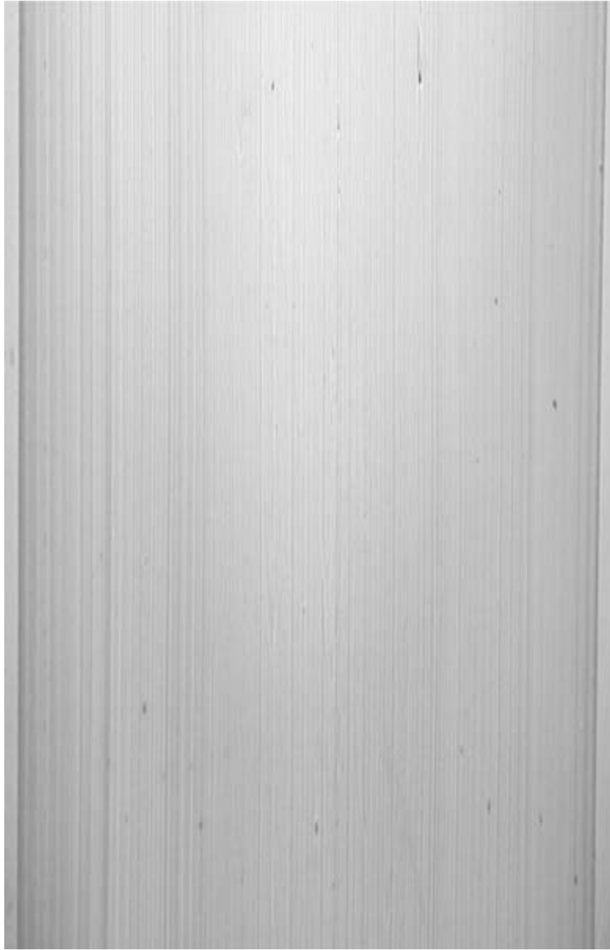
FIG. 2.17 – Photo d’un échantillon “stable” recueilli en sortie de filière porte-manteau ; débits approximatifs Q_{PE} = 2775\text{mm}^3/\text{s} , Q_{PS} = 651\text{mm}^3/\text{s} à 200^\circ\text{C}
