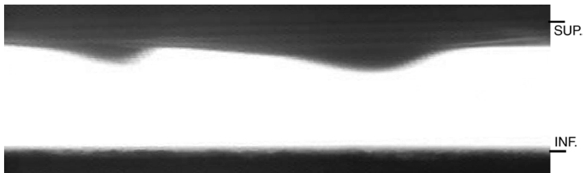
FIG. 4.27 – Vue à fort grossissement d'un écoulement "spontanément" instable
