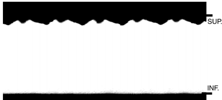
FIG. 4.33 – Apparition d'un défaut "secondaire" : diagramme h(t) en x=37mm obtenu pour un forçage périodique à la fréquence 0,64Hz
