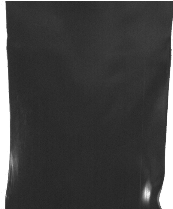
FIG. 4.30 – Photographie de l'extrudat obtenu à 180^{\circ}C pour les débits Q_{PE} = 87,4 g/min et Q_{PS} = 7,4 g/min , entrefer fixé à 2mm
