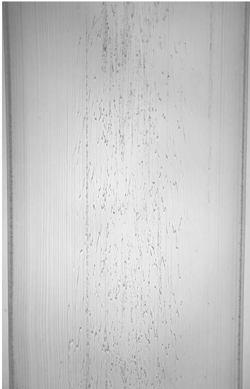
FIG. 2.20 – Photo d’un échantillon “très instable” recueilli en sortie de filière porte-manteau ; débits approximatifs Q_{PE} = 3467\text{mm}^3/\text{s} , Q_{PS} = 324\text{mm}^3/\text{s} à 200^\circ\text{C}
