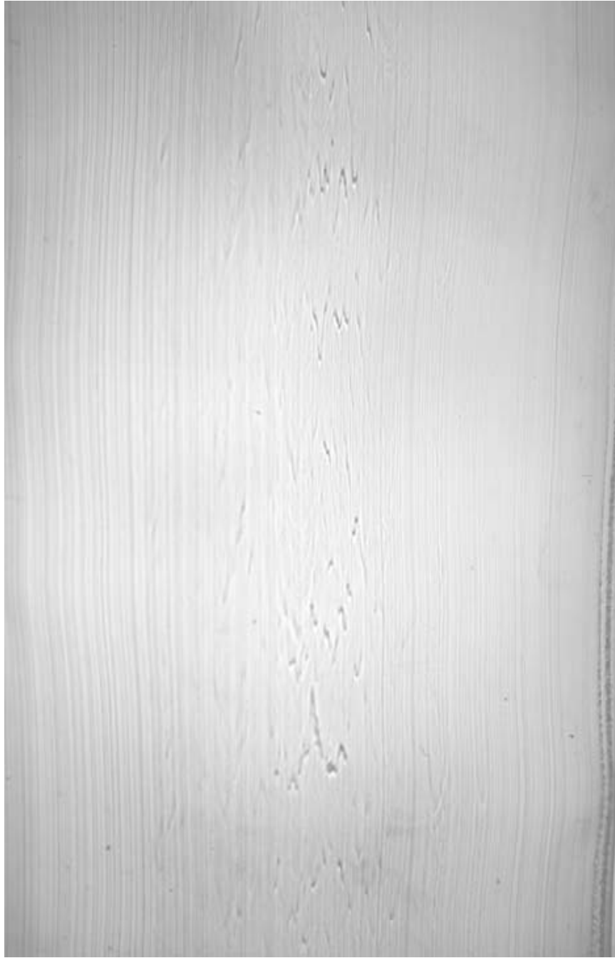
FIG. 2.19 – Photo d’un échantillon “légèrement instable” recueilli en sortie de filière portemanteau ; débits approximatifs Q_{PE} = 3467mm^3/s , Q_{PS} = 471mm^3/s à 200^{\circ}C
