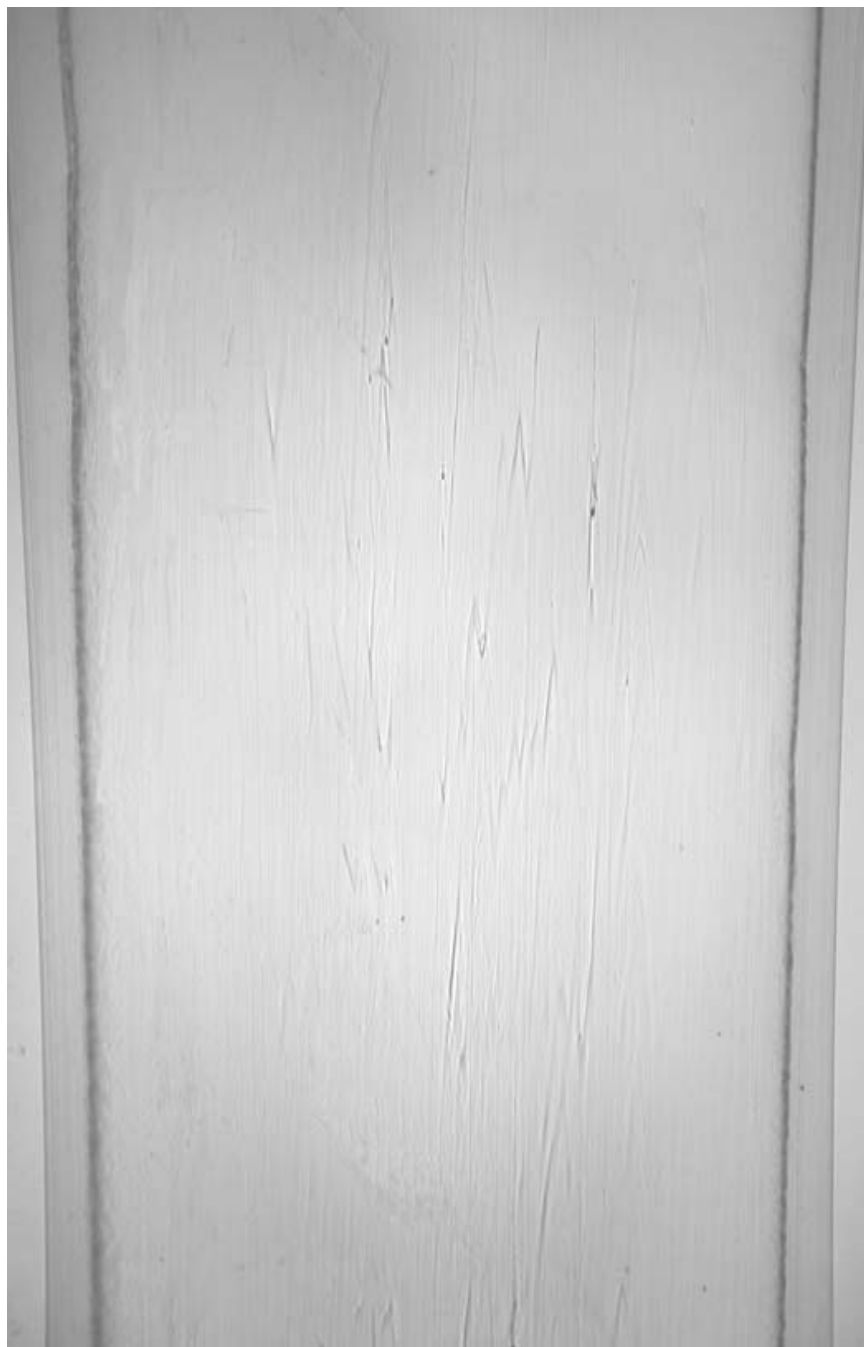
FIG. 2.18 – Photo d'un échantillon "légèrement instable" recueilli en sortie de filière portemanteau ; débits approximatifs Q_{PE} = 1928\text{mm}^3/s , Q_{PS} = 440\text{mm}^3/s à 180^\circ\text{C}
