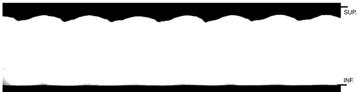
FIG. 4.23 – Diagramme h(t) construit à partir d'une configuration perturbée à une fréquence 0,49Hz pour l'abscisse x=31mm , Q_{PE} = 87,4 g/min , Q_{PS} = 7,4 g/min , entrefer fixé à 2mm ; on note la position des bords supérieur et inférieur de la filière
