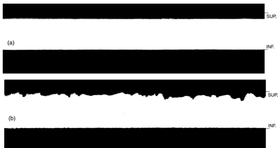
FIG. 4.28 – Diagrammes h(t) construits pour une configuration “spontanément” instable, (a) : abscisse 5\text{mm} , (b) : abscisse 35\text{mm} ; durée 15\text{s}
