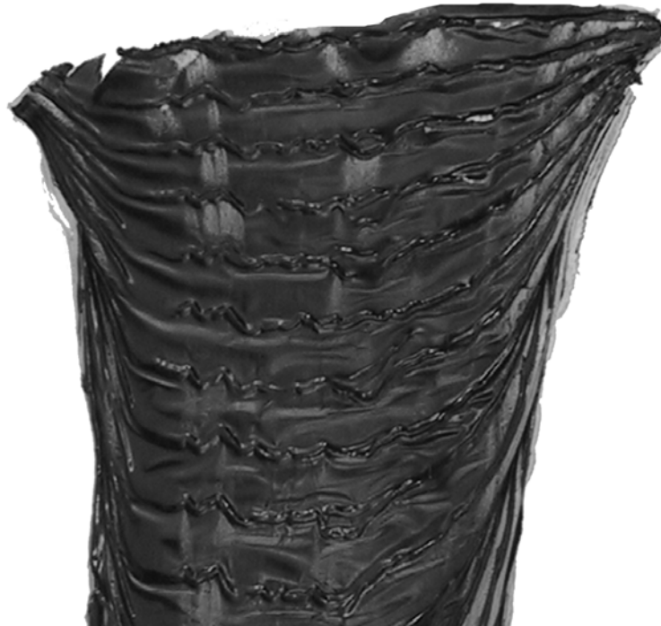
FIG. 4.31 – Photographie de l'extrudat recueilli en sortie de filière pour la configuration obtenue à 180^{\circ}C , avec Q_{PE} = 87,4 g/min , Q_{PS} = 7,4 g/min , entrefer fixé à 2mm , la partie supérieure de l'extrudat vient d'être coupée de la sortie de la filière
