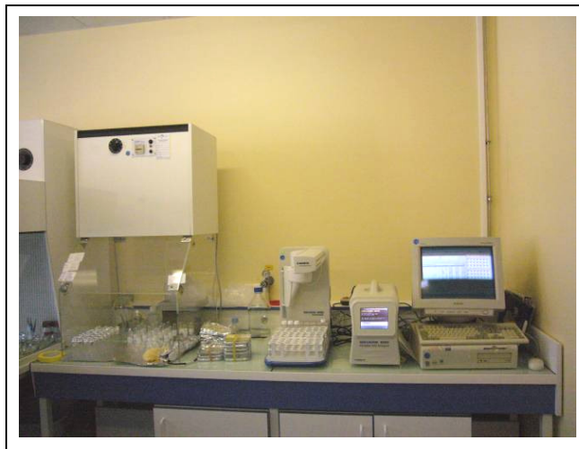
Figure 14 : Photo de l'instrument TOC, du passeur et de la hotte pour l'extraction au LSCE.
