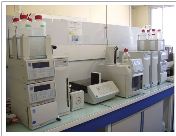
Figure 7 : Photo des chaînes d'analyse chromatographique cationique/anionique.
