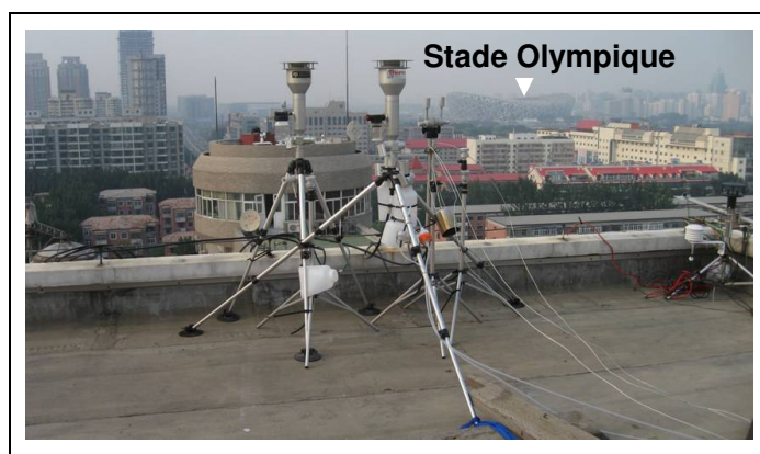
Figure 72 : Photo des lignes de prélèvement, toit de l'IAP.
