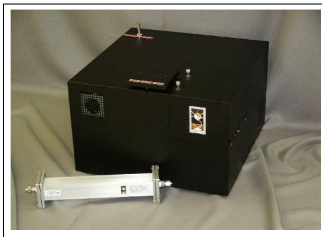
Figure 19 : Photo de l'instrument EC-OC Sunset Field Analyzer.
