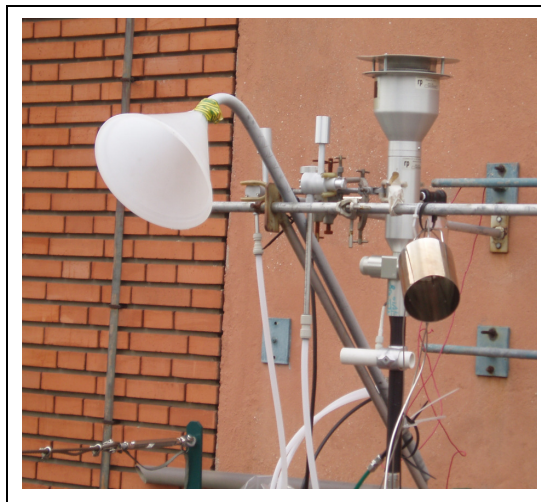
Figure 63 : Photo des têtes systèmes de coupure PM_{2.5} .
