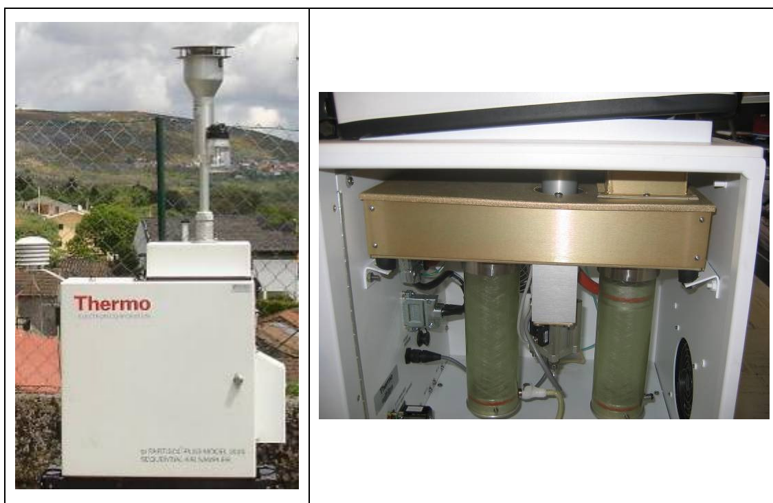
Figure 4 : Photo du préleveur automatique PARTISOL PLUS®.
