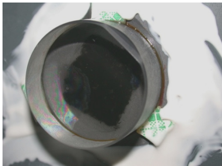
Figure 4-4 : Présence de bulles à l'interface - essai Pyr01.
