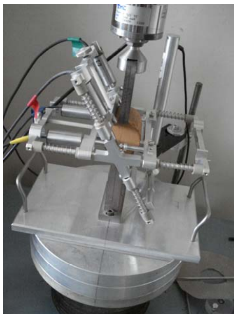
Figure 2.12 : Dispositif de mesure de la résistance à la traction brésilienne
