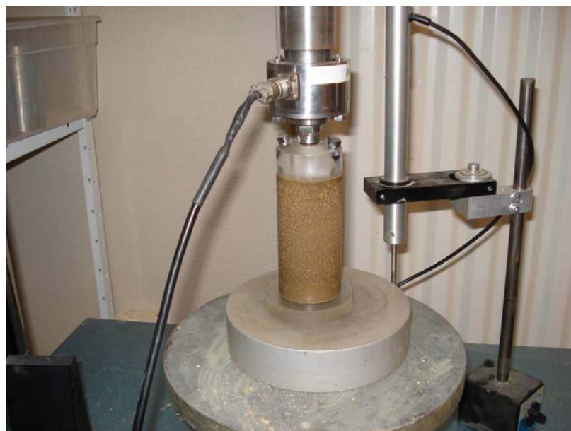
Figure 2.13 : Dispositif de mesure de la résistance à la compression simple
