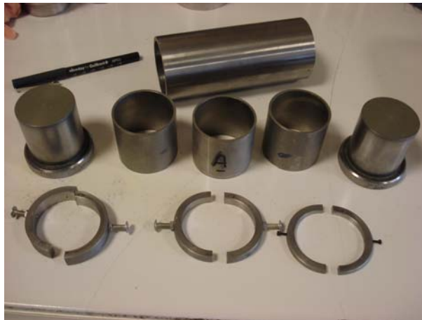
Figure 2.11 : Équipement de compactage des éprouvettes
