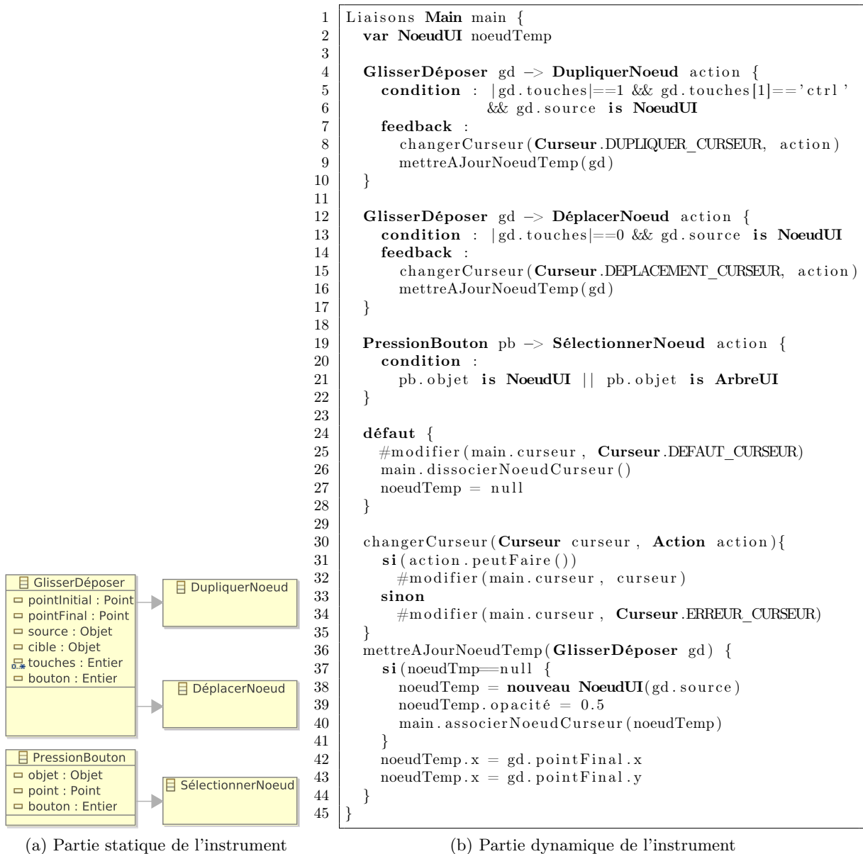
FIG. 8.12: Parties statique et dynamique de l'instrument Main
