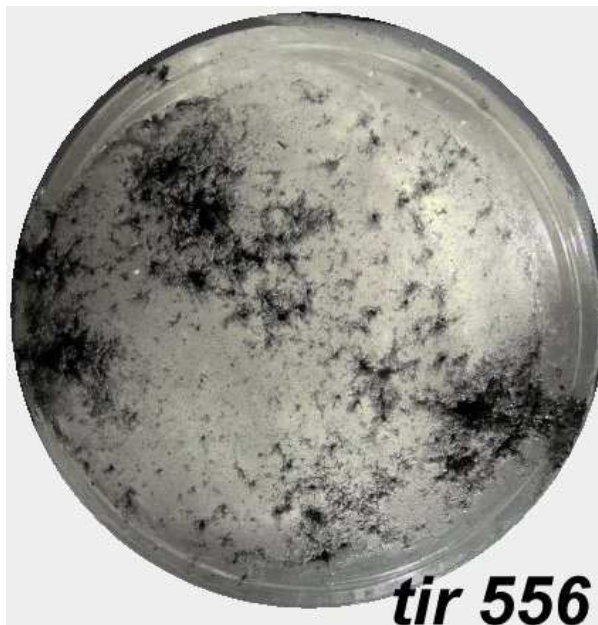
Figure 6.40 Photographie d'un bloc de gel recueilli après l'explosion d'une charge de 95mm contenant le mélange A (tir 556)
