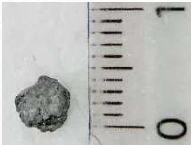
Figure 6.46 Agglomérat de particules d'aluminium de 100µm prélevé dans un bloc de gel
