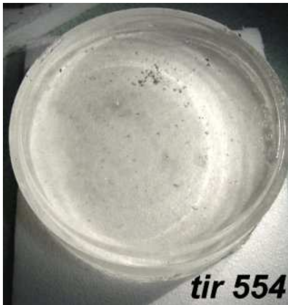
Figure 6.36 Photographie d'un bloc de gel recueilli après l'explosion d'une charge de 95mm contenant des flocons d'aluminium (tir 554, 95-Al-flakes-0,9)
