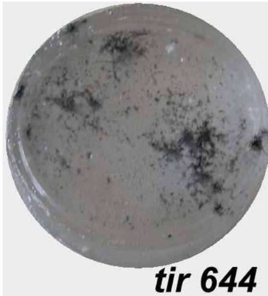
Figure 6.43 Photographie d'un bloc de gel recueilli après l'explosion d'une charge de 95mm contenant le mélange B (tir 644)
