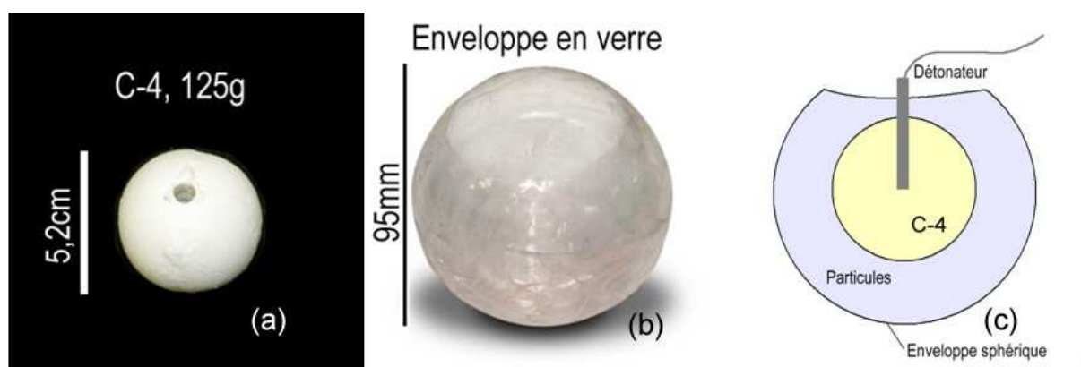
Figure 3.1 (a) Booster de 125g de C-4 sphérique (le trou dans l'explosif est destiné à accueillir le détonateur), (b) enveloppe en verre et (c) schéma de la charge
