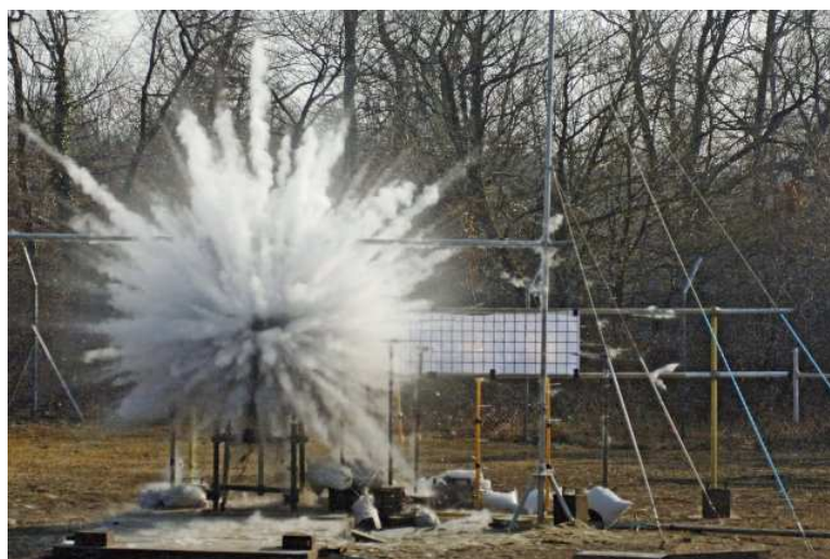
Figure 5.2 Photographie instantanée de la dispersion sphérique de billes de verre par explosif
