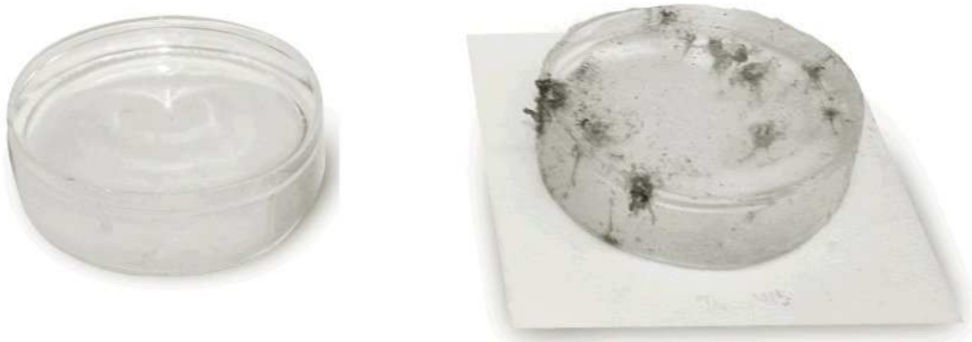
Figure 3.15 Blocs de "Varagel", avant et après un tir de charge aluminisée (diamètre 19cm)
