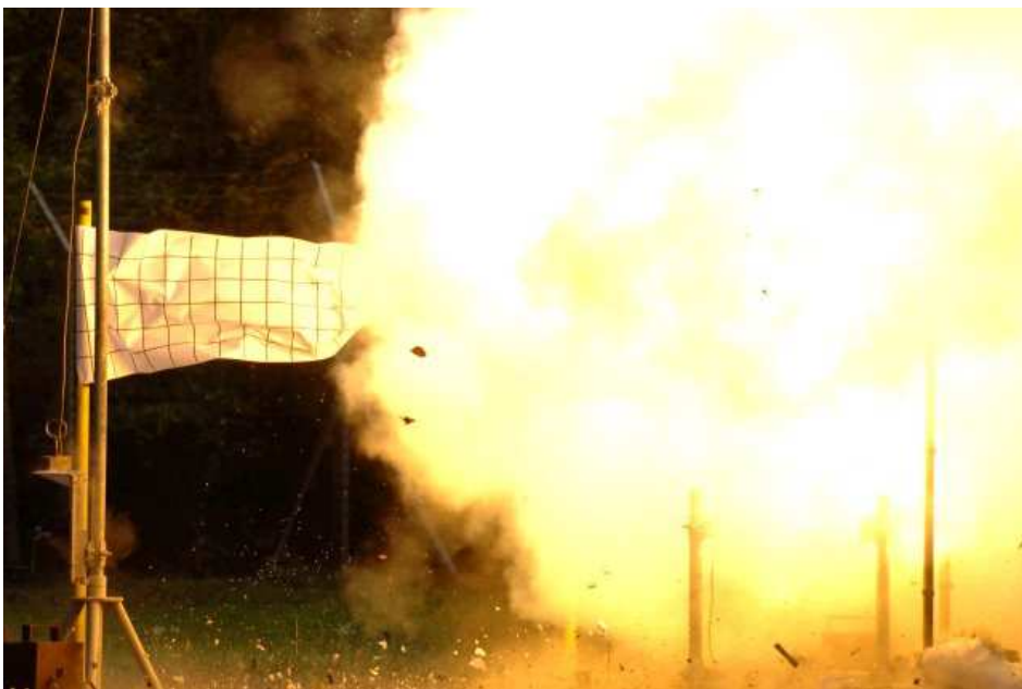
Figure 6.1 Photographie de la dispersion sphérique et de la combustion de flocons d'aluminium par explosif (95-Al-flocons-0,9)
