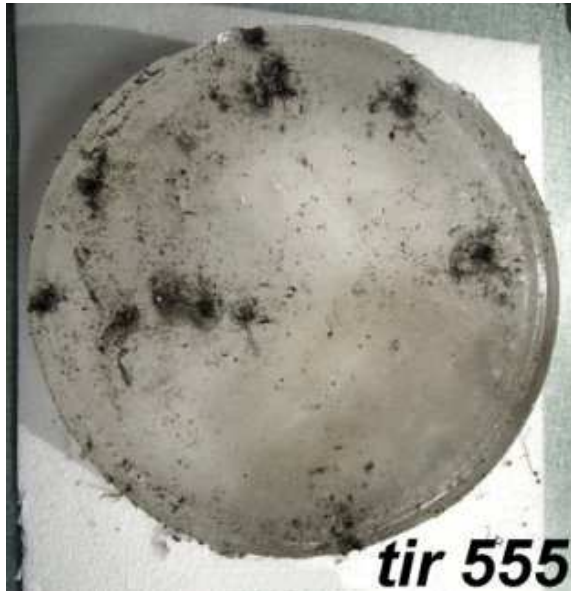
Figure 6.38 Photographie d'un bloc de gel recueilli après l'explosion d'une charge de 95mm contenant des particules de magnésium (tir 555, 95-Mg-1,5)
