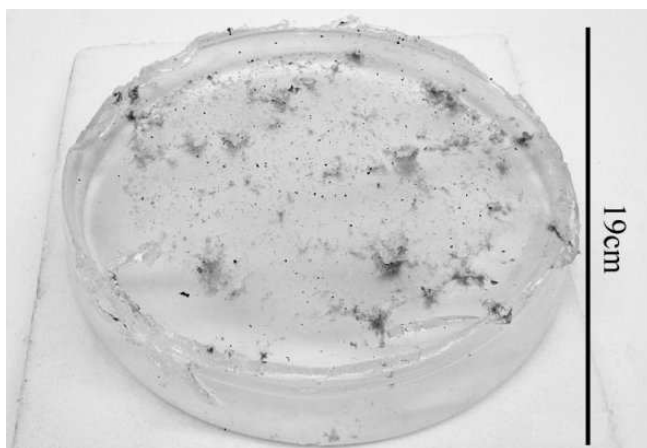
Figure 5.21 Photographie d'un bloc de gel ayant servi à la capture de particules inertes (tir 419, 95-V-100 \mu m-3,7)
