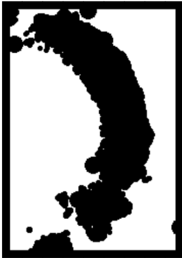
FIG. 3.33 — Carte de poids (la diagonale de W^{\text{psf}} ) utilisée dans les itérations d'estimation de la PSF ; en noir 0, en blanc 1.
