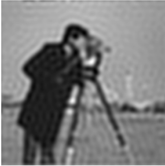
FIG. 1.9 — Reconstruction tronquée avec une fréquence de coupure u_{\text{coupure}} = 20 frequels (EQM = 27.0 dB).
