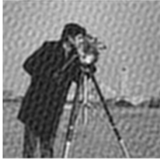
FIG. 1.10 — Reconstruction tronquée avec une fréquence de coupure u_{\text{coupure}} = 40 frequels (EQM = 26.2 dB).
