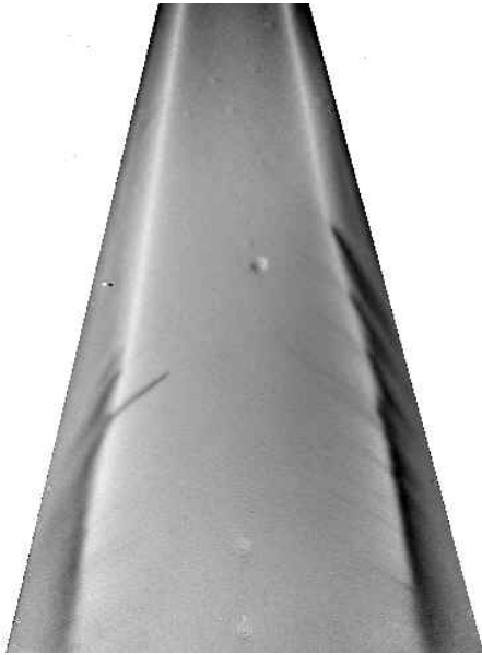
Fig. 5.36 – Image de dégradation de la PSP obtenue après 45min d’essai, à l’extrado d’une aile Delta en incidence, dans un écoulement à faible vitesse. Plus le ton est sombre, plus la dégradation est importante.
