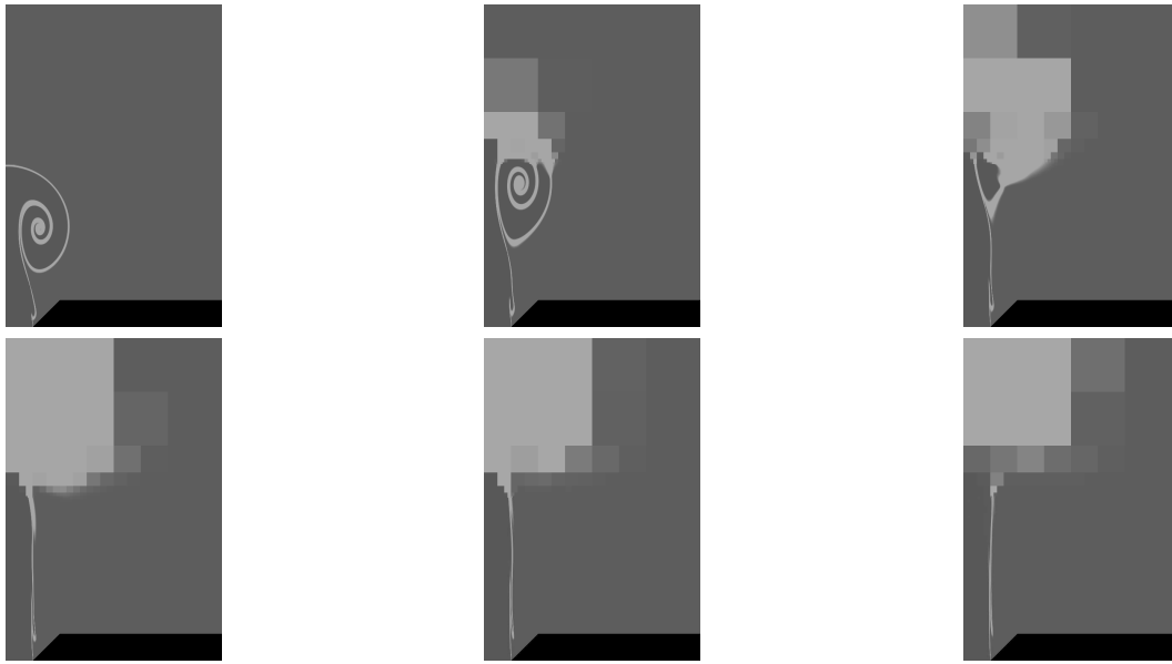
FIG. 3.5: Simulation de naissance de jet dont les conditions de sortie fluide sont accompagnées d'une baisse de la résolution du maillage. La frontière de gauche du domaine impose une condition de symétrie
