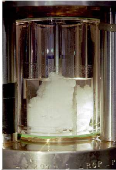
Figure 3 : Formation d'hydrates de gaz dans un réacteur agité transparent [source IFP].
