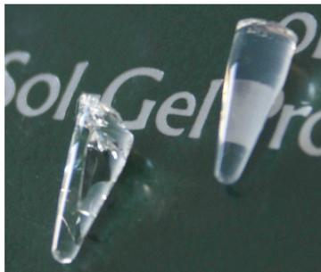
FIG. 4.3: Xérogels SG<sub>0</sub>-Me-40 (gauche) et SG<sub>0</sub>-Me-20 (droite)
