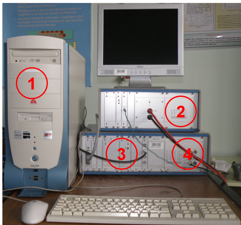
Figure II-1.2-1. Impédancemètre, 1- PC de contrôle, 2- Potentiostat PP240 forte puissance, 3-Analyseur de spectre, 4- Potentiostat IM6 faible puissance.
