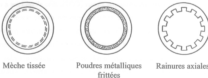
Figure 1.20 : Réseaux capillaires les plus répandus
