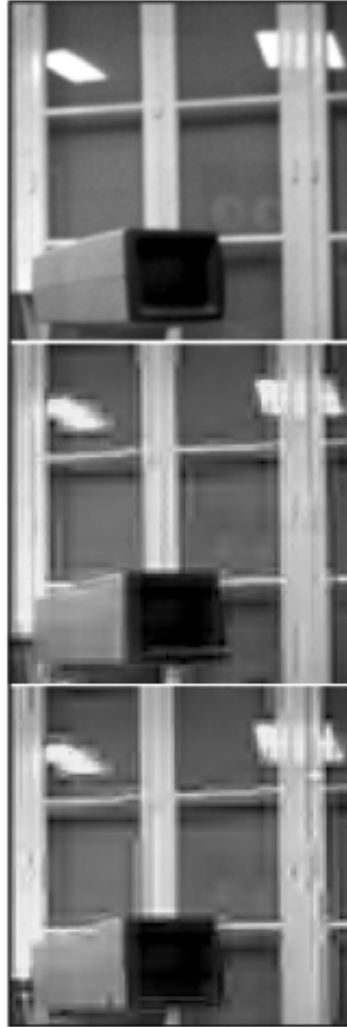
FIG. 4.2 – Exemple d'image codée/décodée avec une QVA à 0,8 bpp. Image du haut : originale. Image du milieu : modèle de distribution elliptique - PSNR=27,7 dB. Image du bas : modèle de distribution sphérique - PSNR=26,1 dB.
