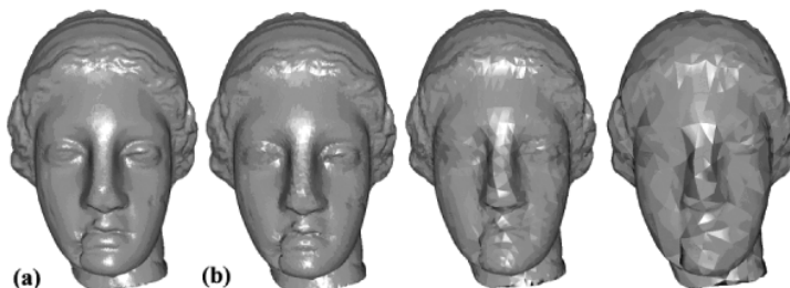
FIG. 2.7 – Image VENUS : exemple de maillages multirésolutions. (a) : maillage original, (b) : différentes résolutions d’approximation. L’information perdue entre deux niveaux de résolution est contenue dans les sous-images de coefficients d’ondelettes.
