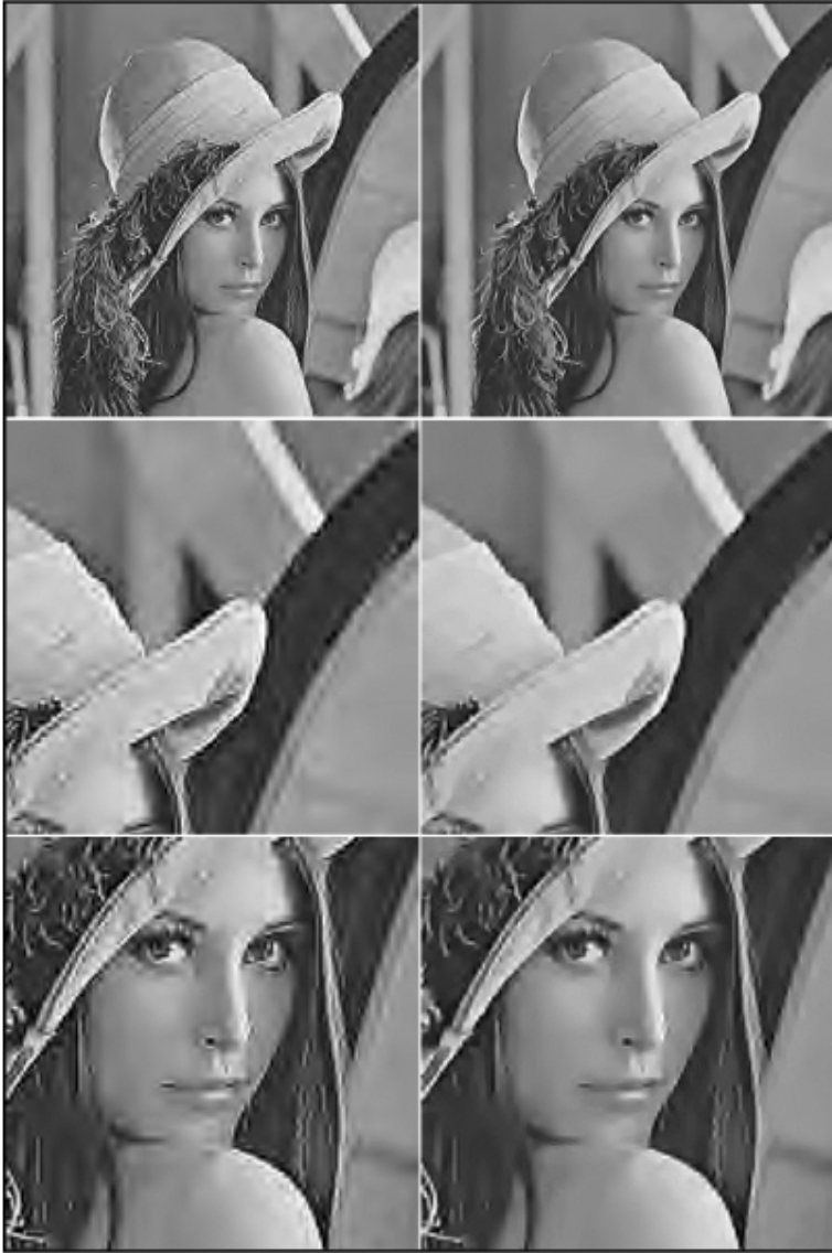
FIG. 5.1 – Décodage optimal de l'image LENA comprimée avec un taux de compression de 86 :1 (0,093 bpp). Images de gauche : décodage standard par filtrage inverse linéaire - PSNR=30,18 dB. Images de droite : décodage par MORPHE - PSNR=31,21 dB.
