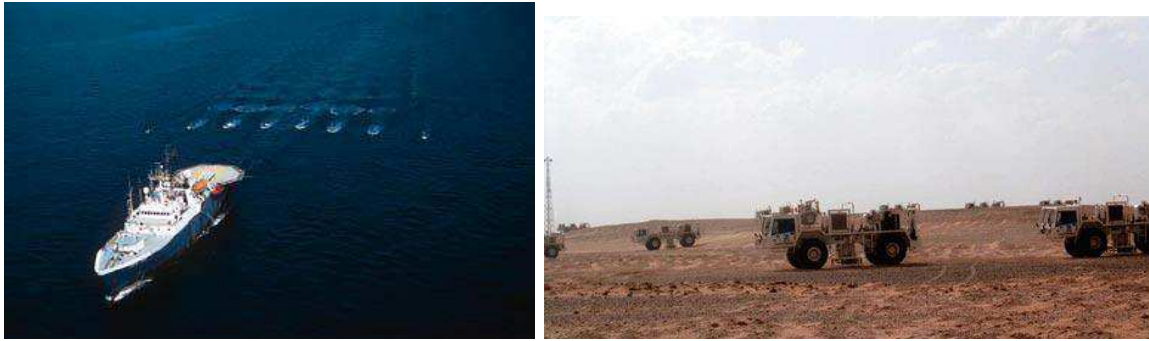
FIG. 1.1 – Campagnes sismiques réelles marine et terrestre.
