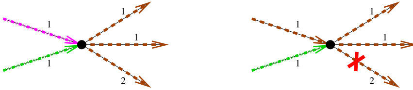
FIG. 5.9 – Deux fibres, plusieurs multicasts : deux exemples de coloration, l'un valide (à gauche), l'autre non (à droite).
