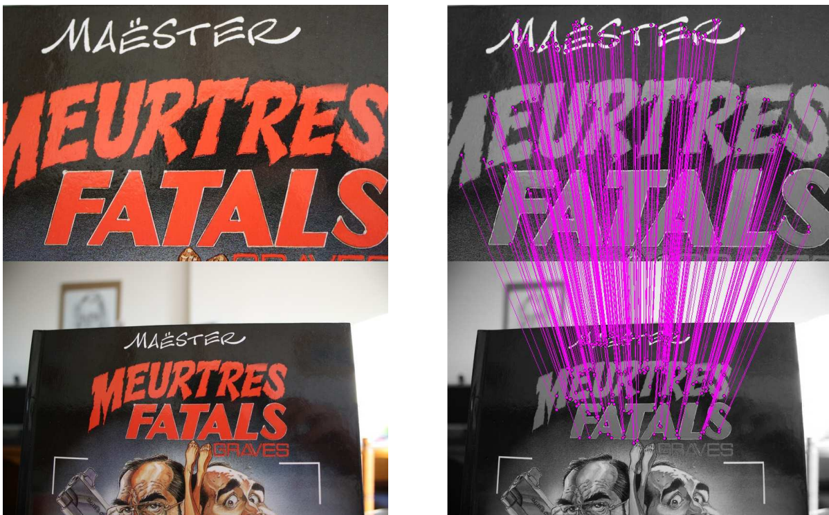
(a) À gauche : Zoom sur un objet plan. À droite : groupe de correspondances de points d'intérêt sélectionnées (la similitude obtient le score le plus élevé, voir le tableau 4.7).
