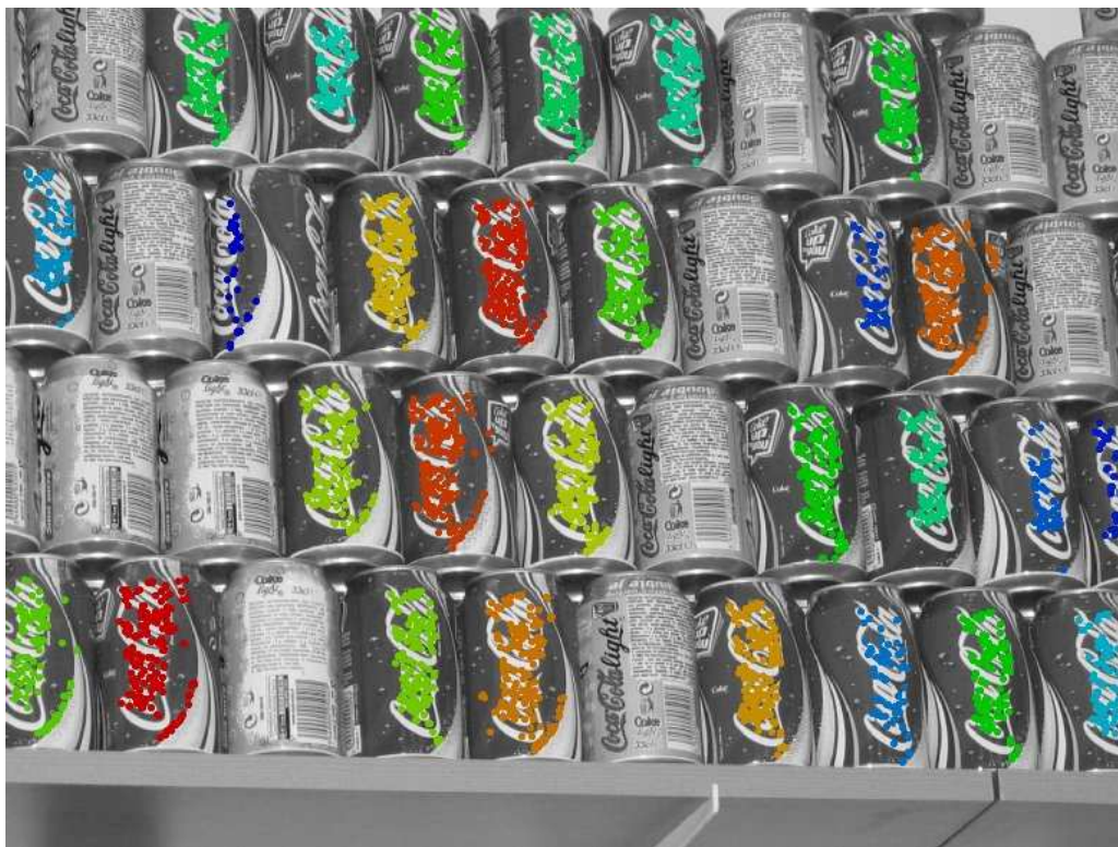
(b) Résultat du groupement avec MAC-RANSAC : les 28 occurrences de l'objet recherché sont reconnues.
