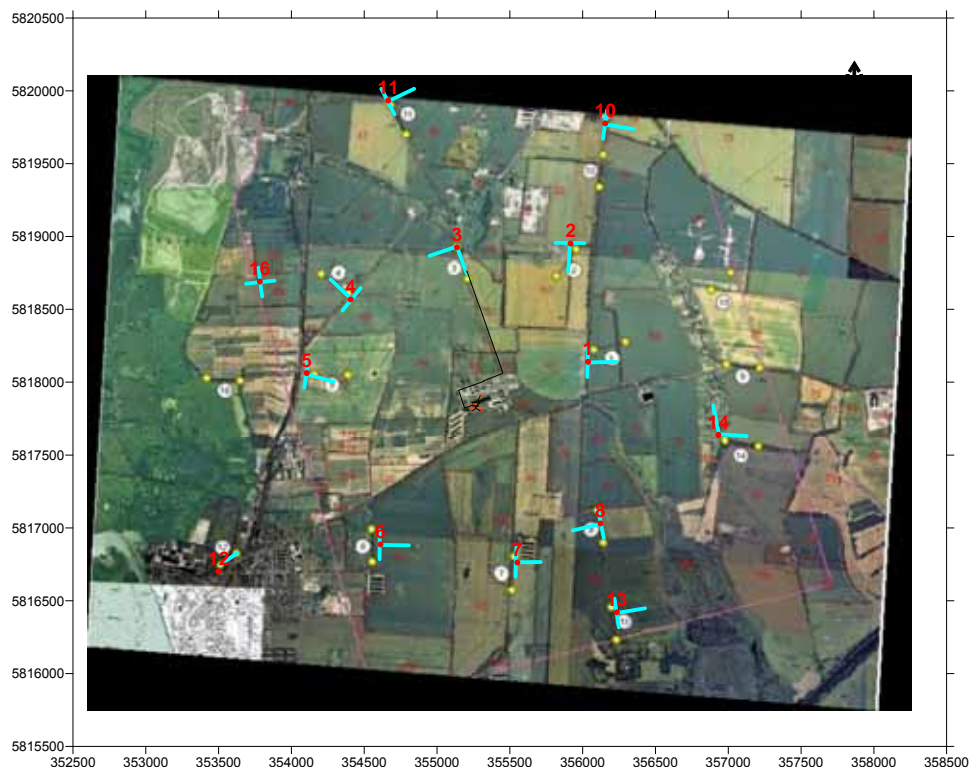
Figure 35 Application du monitoring CSEM du stockage de CO 2 sur le site pilote de Ketzin (CO 2 SINK, Allemagne)
