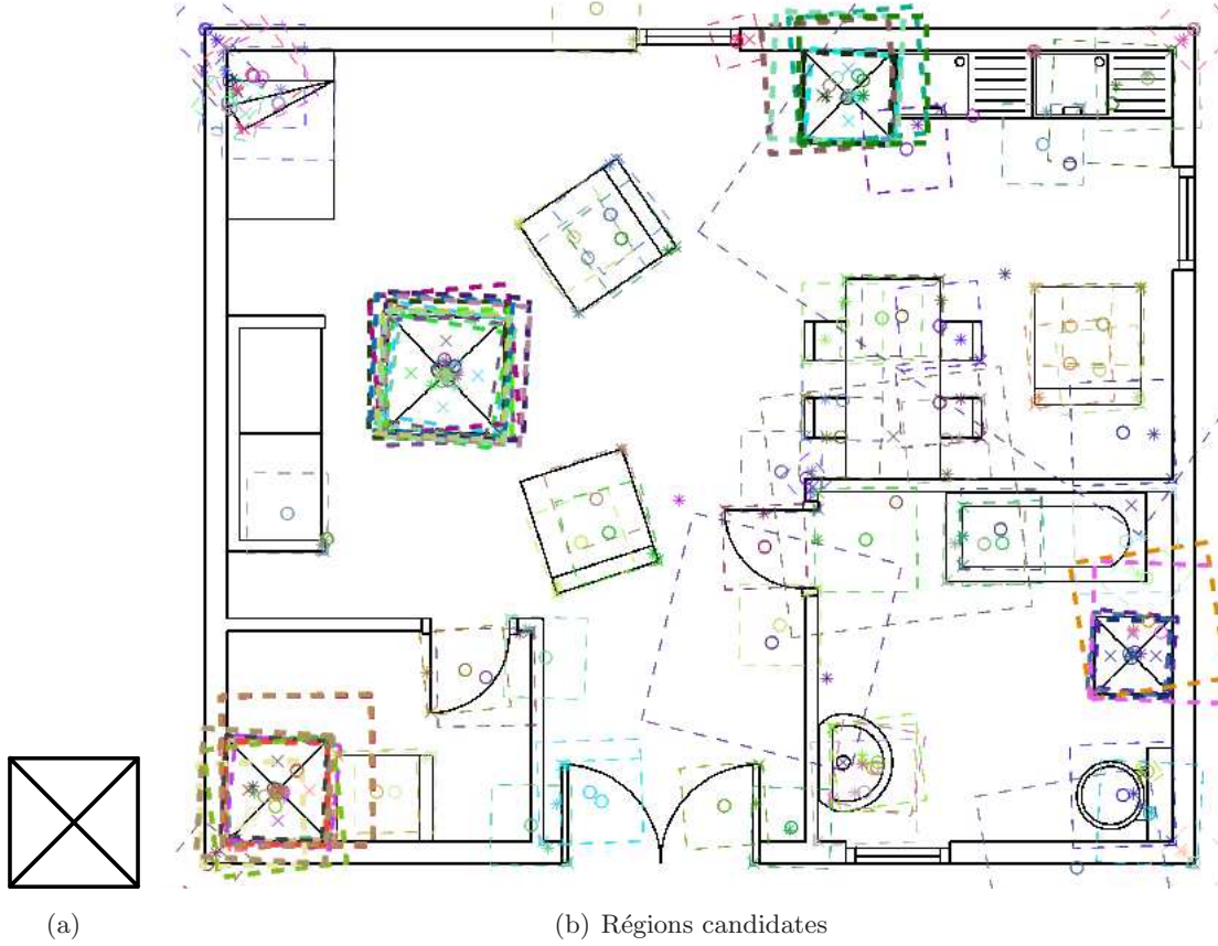
FIG. 5.8 – (a) Symbole requête. (b) Régions candidates correspondantes dans le document. L'épaisseur du trait des rectangles représente la similarité entre la requête et ces régions.
