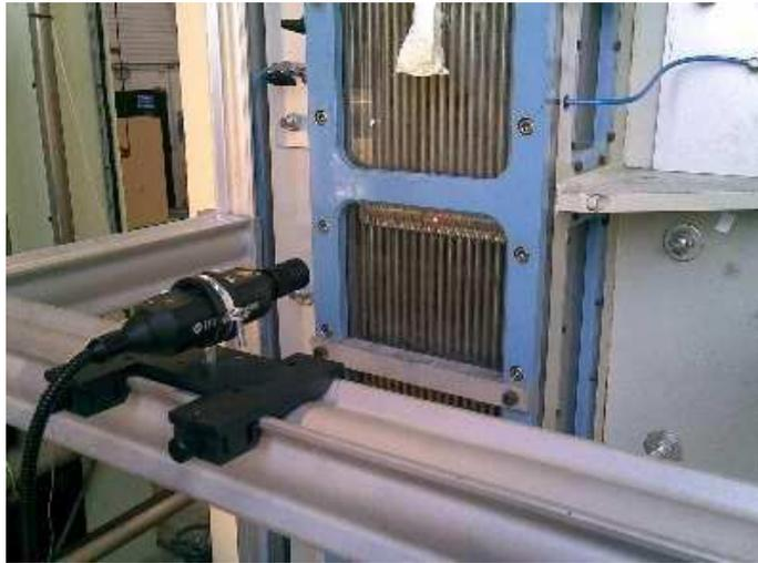
FIG. 8.5 – Vibromètre laser.
