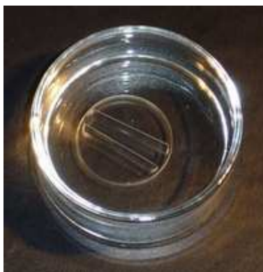
Figure 29 : Immersion dans de l'eau désionisée d'allumettes de silice adhérees sur un substrat de silice.
