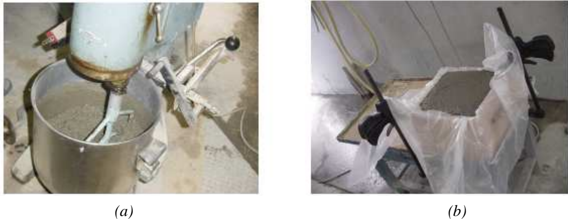
Figure 2-6 : Mise en œuvre du coulage de béton
