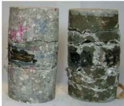
Figure 4-12 : Faciès de rupture de deux essais différents, testés à 100 MPa de confinement, sur les échantillons très humides ( S_r=85\% ) : essai stoppé à 9,5% de déformation axiale globale (à gauche) et essai stoppé à 16,3% de déformation axiale globale (à droite)
