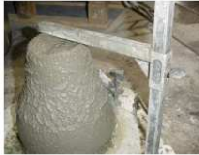
Figure 2-3: Mesure de l'affaissement du béton frais R30A7 au cône d'Abrams (Affaissement moyen 6,9 cm)
