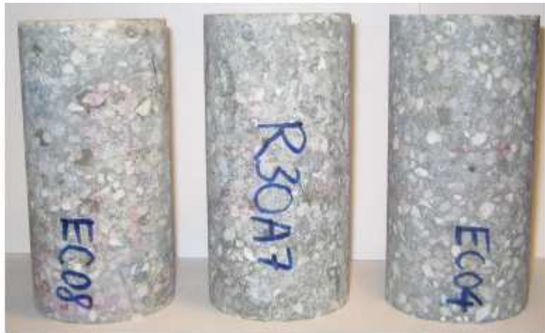
Figure 2-19 : Echantillon des bétons EC08, R30A7, EC04 (dimension 7x14 cm) après préparation de la surface latérale
