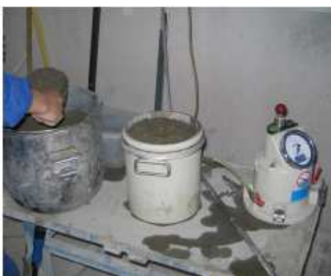
Figure 2-5 : Mesure de l'air d'occlus du béton frais à l'aide de l'aéromètre
