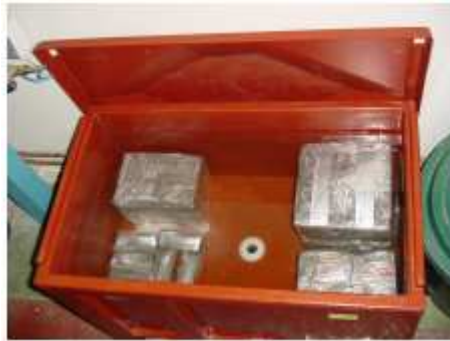
Figure 2-7 : Conservation des blocs de béton après coulage et d' éprouvettes saturées après usinage
