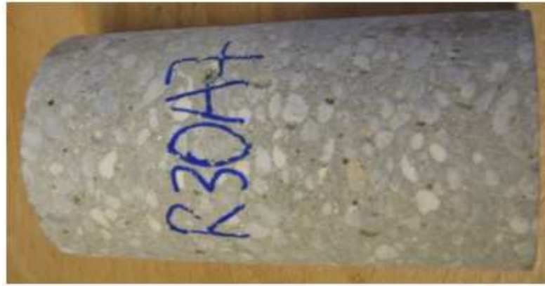
Figure 2-9 : Echantillon de béton R30A7(dimension 7 x14 cm) après usinage
