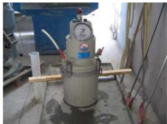
Figure 2-5 : Mesure de l'air d'occlus du béton frais à l'aide de l'aéromètre
