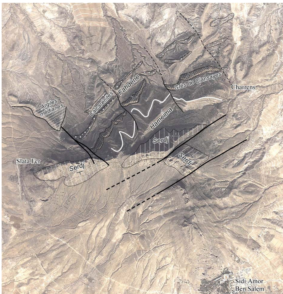
Figure III.10. Jebel Slata (image satellite de Google Earth). Noter l'obliquité de la Fm Hameima (discordance) sur la surface supérieure de la Fm Serdj, au Nord du sommet principal, et la faille orientée NW-SE, scellée par les argiles médianes (Albien supérieur) au NW.
