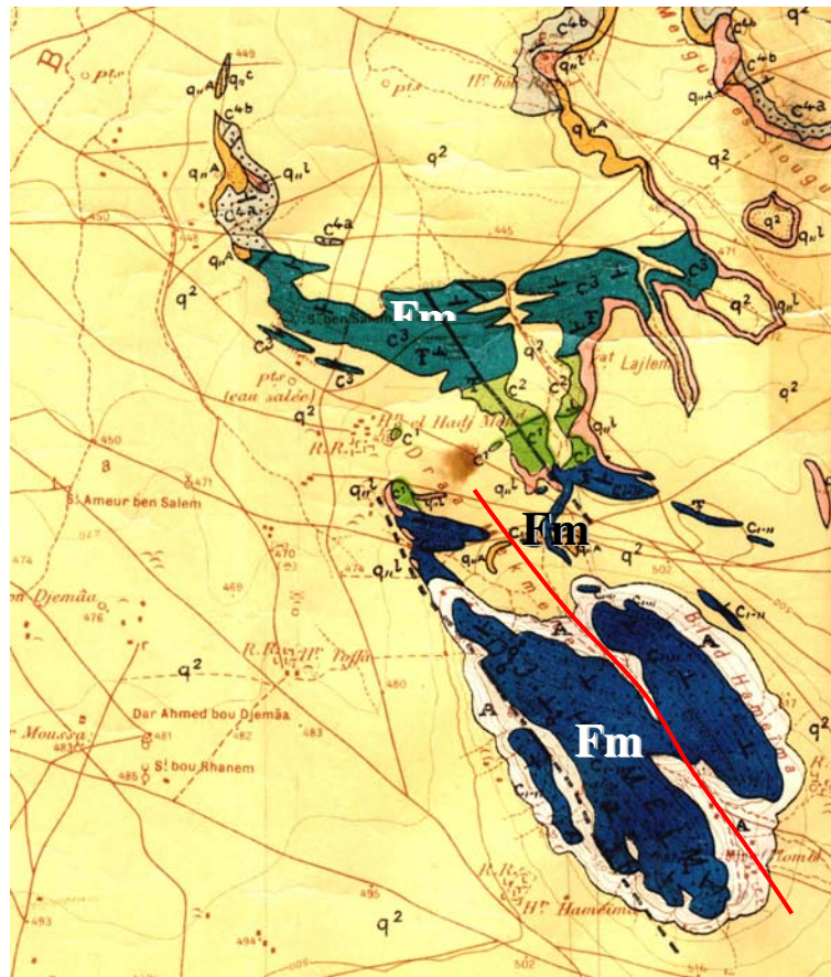
Figure III.3. Carte géologique du Jebel Hameïma (Dubourdieu, 1956). La faille principale (en rouge) qui découpe le jebel coupe aussi la Fm Hameïma, et montre les mêmes caractéristiques que celles qui coupent la Fm Fahdène plus au Nord. Elle serait donc post-albienne. Comparer avec la Figure III.5.
