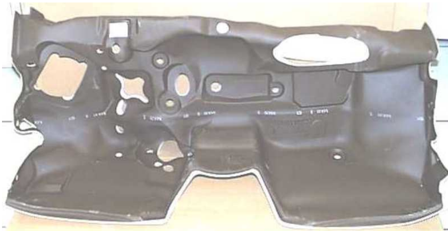
FIG. 1 – Exemple d’habillage de tablier
