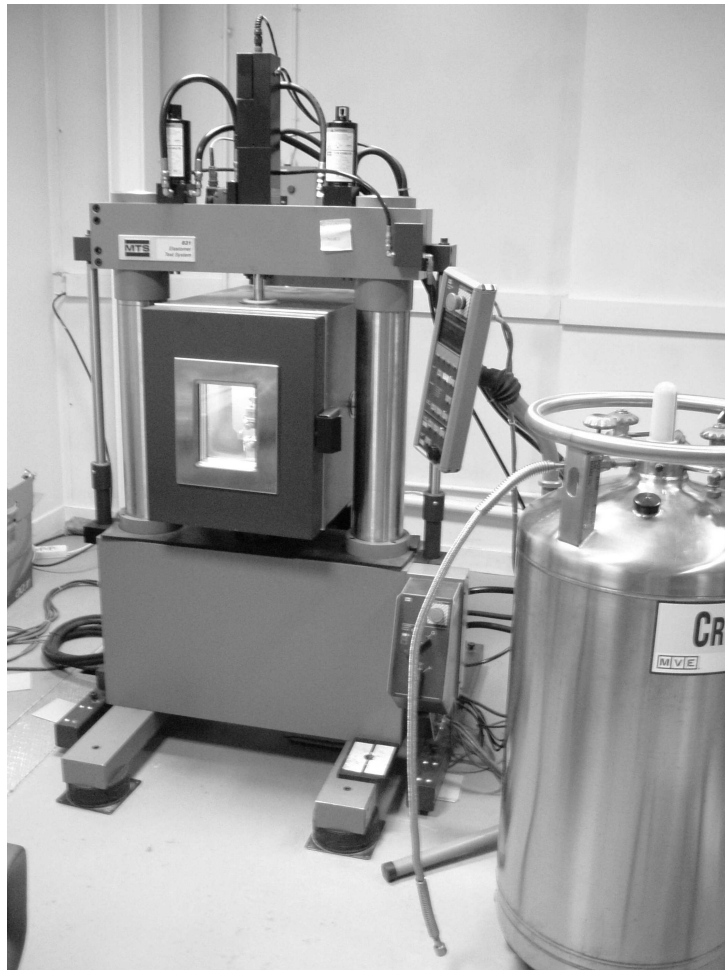
FIGURE II.2 – Machine de traction MTS avec four et bombone d'azote liquide.
