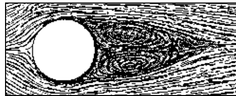
Fig. 2 : dépressions à l'arrière du cylindre
