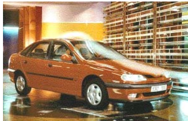
Etude de l'écoulement du flux sur une Renault Laguna
