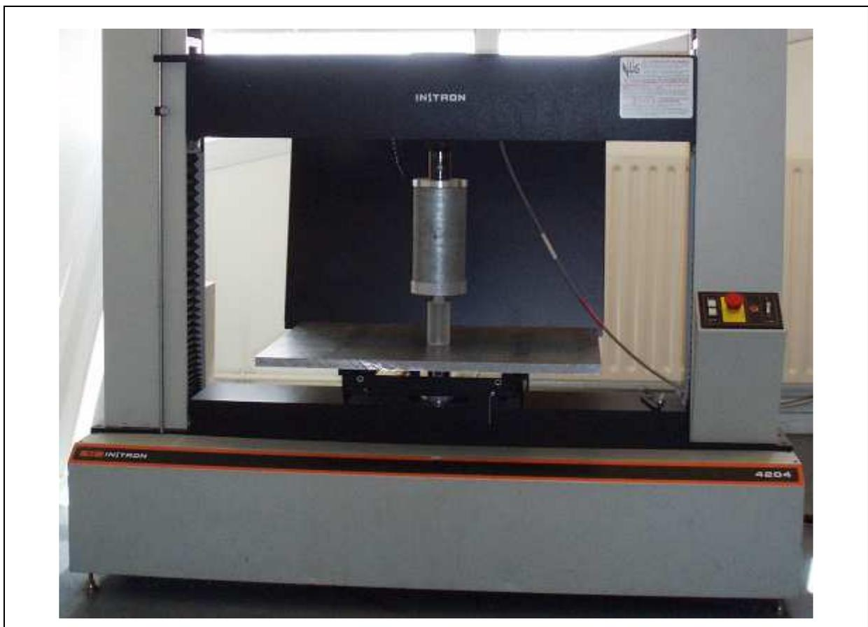
Figure 73 : Machine de test INSTRON 4240 avec le montage en compression.
