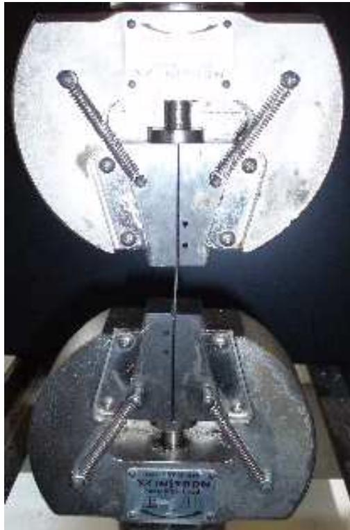
Figure 64 : Machine de test INSTRON 4240 avec le montage en traction.
