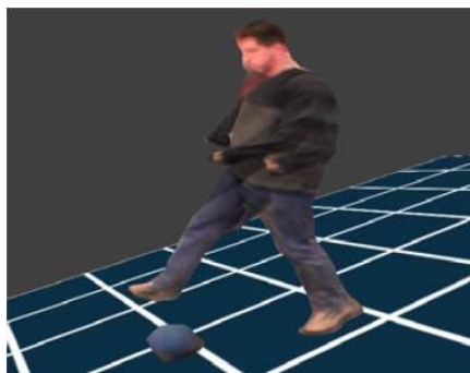
FIG. 80: Visual hull obtenu par la méthode de [MBM01] Copyright : Matusik, Buehler et McMillan
