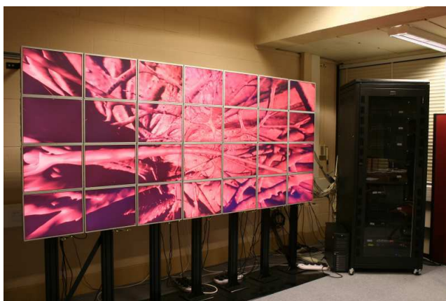
FIG. 7: Exemple d'un Powerwall Copyright : Université de Leeds
