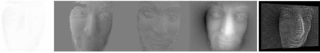
FIG. 71: Exemple de reconstruction utilisant la méthode de stéréoscopie photométrique Copyright : Schindler
