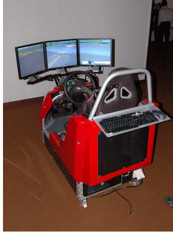
FIG. 17: Exemple de plate-forme de simulation avec l'espace d'analyse à l'arrière
