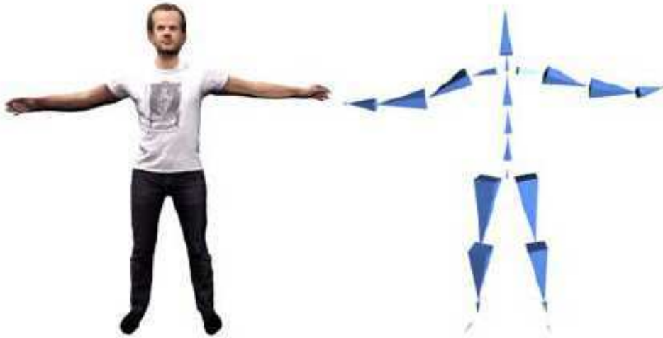
FIG. 73: Exemple de motion capture n'utilisant pas de marqueur Copyright : ballan et cortelazzo
