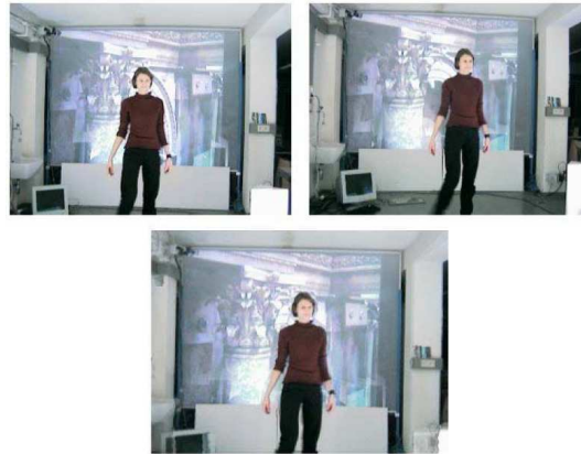
FIG. 68: Génération d'une nouvelle vue en se fondant sur une carte de profondeur générée par la méthode des planes sweep Copyright : Geys
