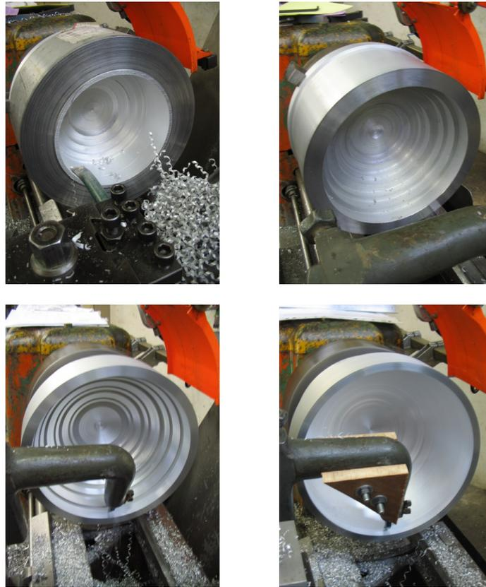
FIGURE 2.2 – Evidage du cylindre 2017A
