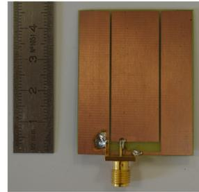
FIGURE 2.34 – Efficacité totale mesurée et photographie de l’antenne coplanaire à fentes
