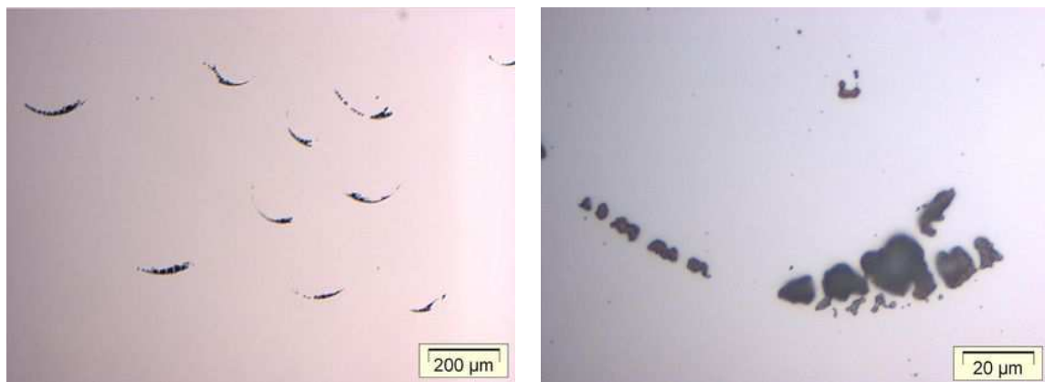
Figure 4.2-20 – Résidus de résine sur certaines plaques après le stripping de l'étape 14.
