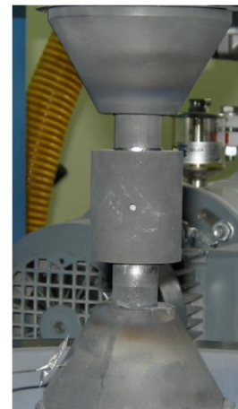
Figure 151 : Appareillage utilisé pour le frittage SPS – La poudre est comprimée à 40 MPa
