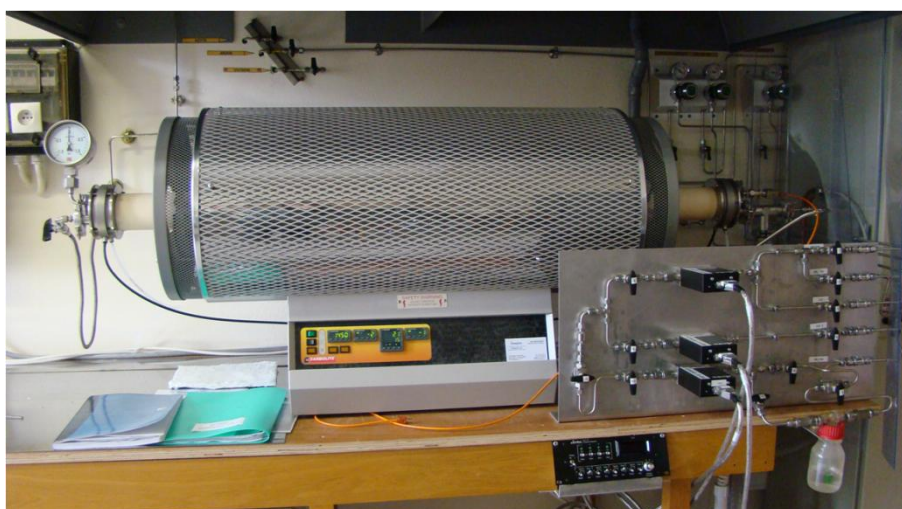
Figure 143 : Photographie du four tubulaire
