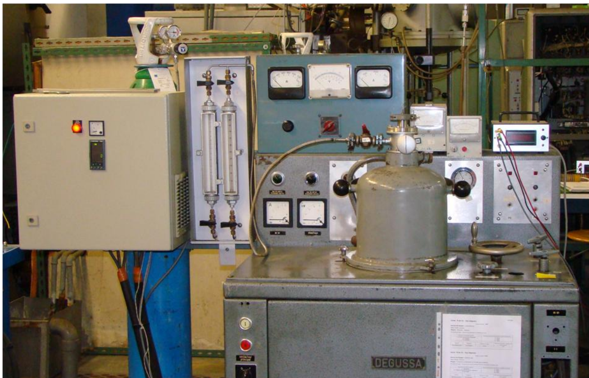
Figure 148 : Photographie du four de frittage à résistor graphite Degussa
