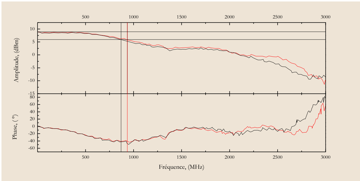
Fig. 5-6 : Caractérisation de la bande passante des photodiodes équilibrées.
