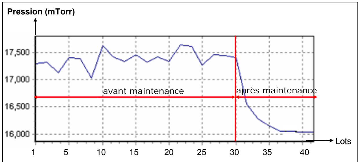
Figure 4.22- Evolution de la pression avant et après une maintenance préventive.
