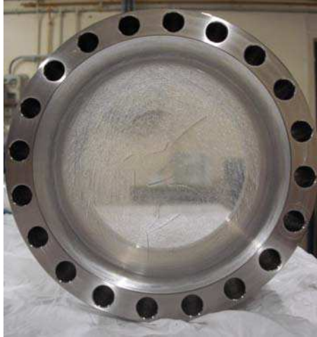
Figure 5-12: Photo d'un des hublots détériorés.
