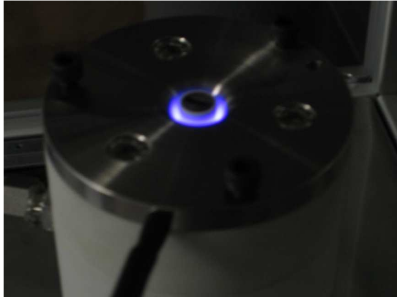
Figure 2-5 : photo de la décharge générée dans le réacteur LEGP-1 tête
