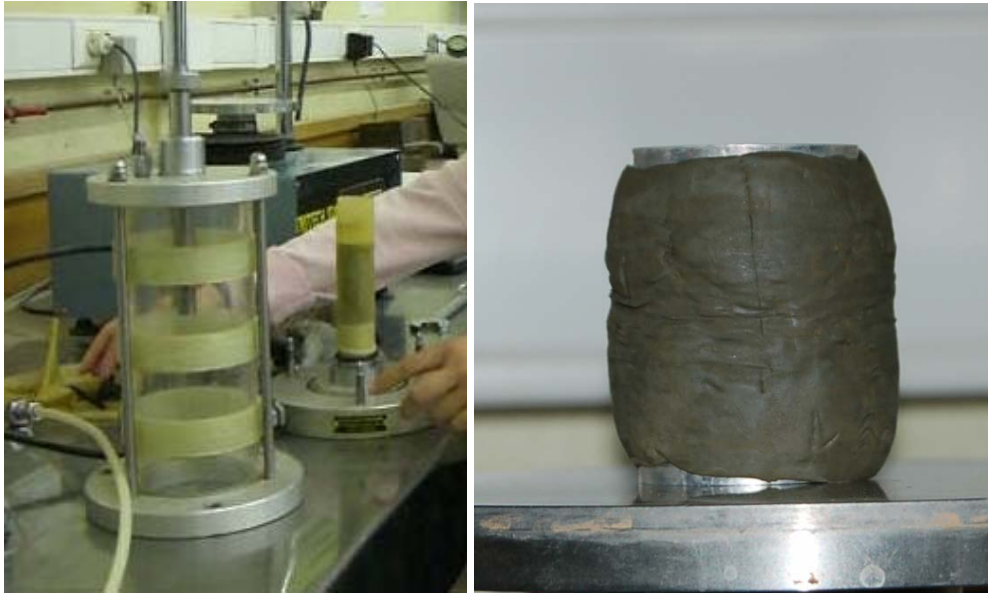
Figure 3-18 : Cellule triaxiale et échantillon testé
