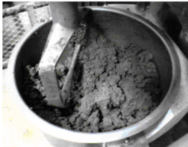
Figure 3-5 : Préparation de l'argile avant le compactage
