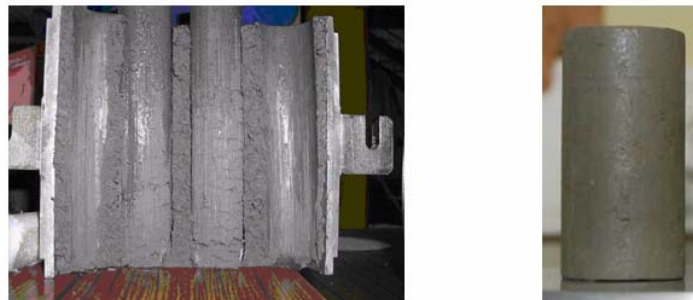
Figure 4-3 : Moule standard CBR et échantillon testé (35 mm x 70 mm)
