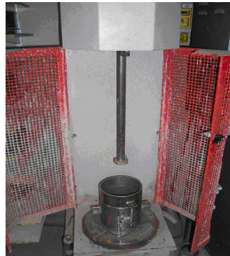
Figure 2-4 : Moule de CBR pour un essai de compactage modifié
