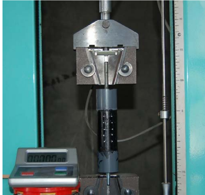
Figure 3-26 : Etalonnage d'un essai de traction directe
