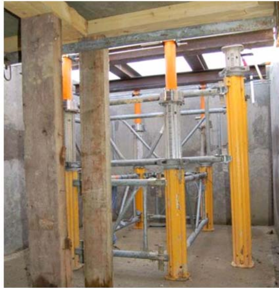
Figure 5-5 : Emplacement des vérins sous la plaque d'essai [Camp, 2008].
