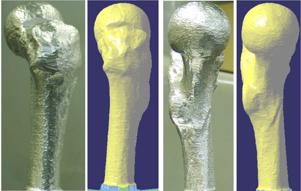
Figure 4.16 : Comparaison entre la simulation et la copie
