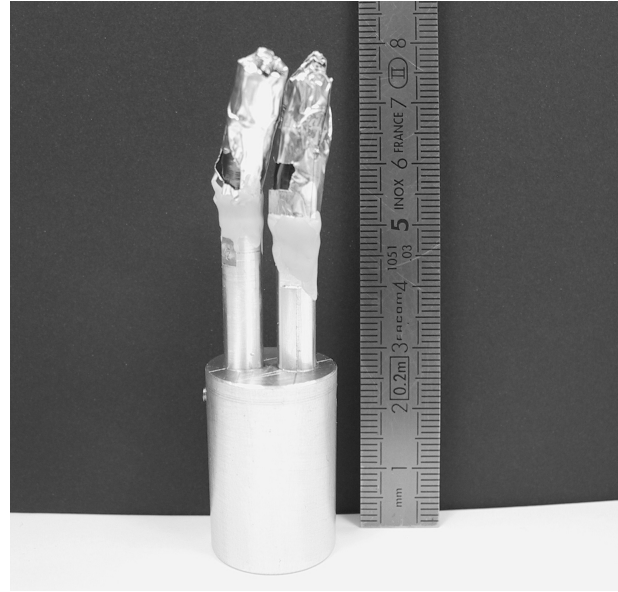
FIGURE 4.17 – Échantillons entourés d'un film d'aluminium et collés sur le support pour l'instrument IN12.
