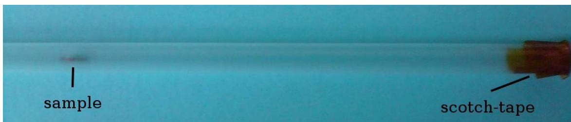
FIGURE 2.9 – Photographie d'un échantillon collé sur un capillaire et placé dans une paille, dont l'extrémité inférieure est recouverte de ruban adhésif. Ainsi, si l'échantillon se décroche du capillaire, il ne tombe pas au fond du cryostat, mais au fond de la paille.
