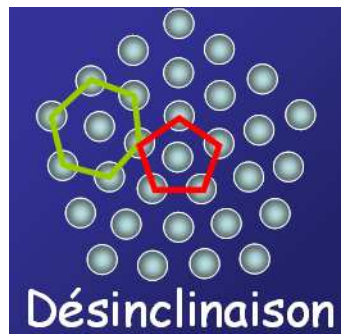
FIGURE 2.2 – Représentation d'une désinclinaison, dont la présence brise la symétrie de rotation.
