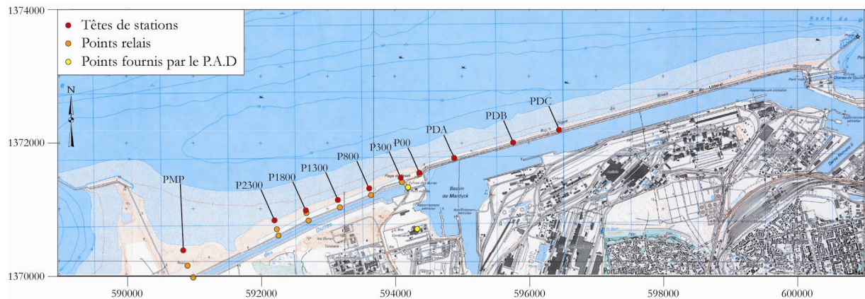
Figure.II.6 : Localisation des têtes de stations, des points relais et des points fournis par le P.A.D au début de l'étude. Source : Carte IGN 1/25000e de Dunkerque.
