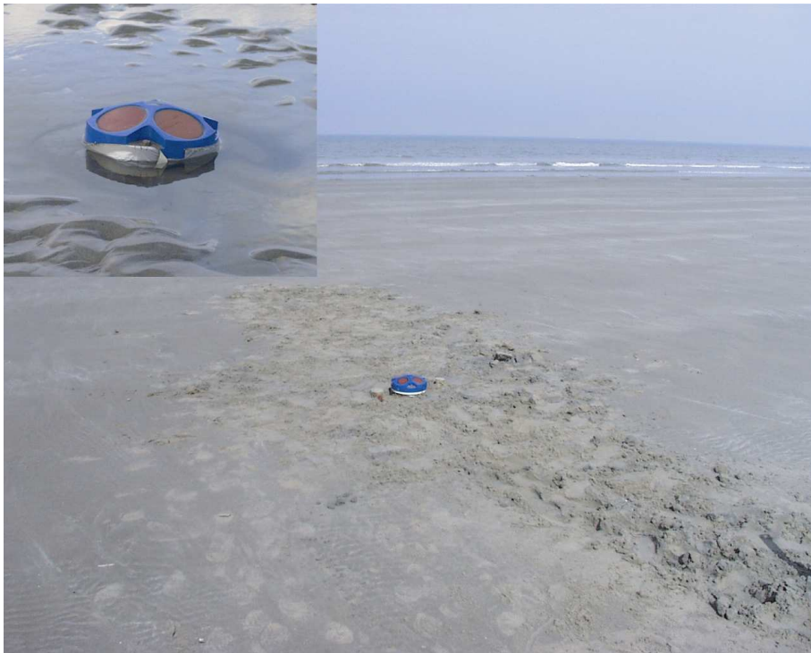
Figure.II.10 : Photographie d'un A.D.C.P mis en place sur l'estran du Clipon.
