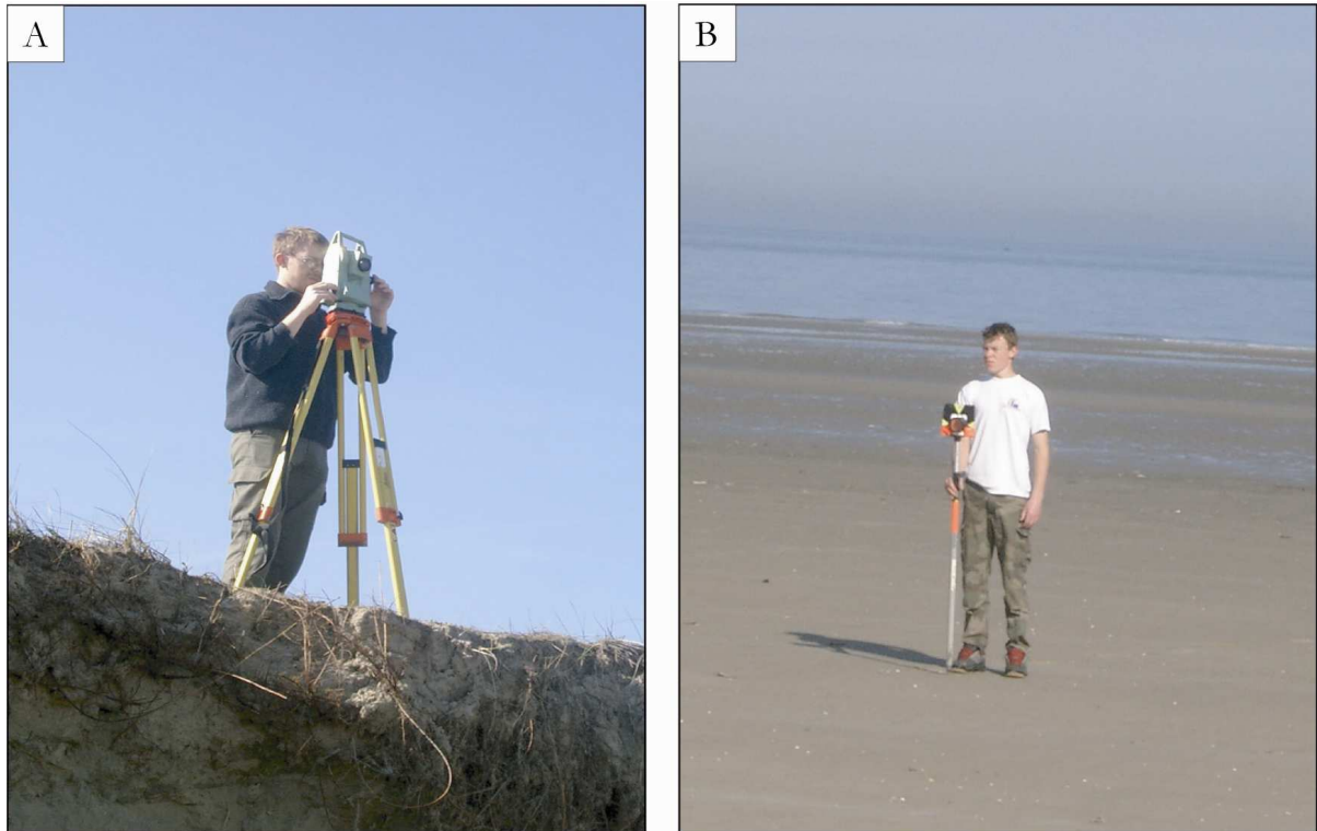
Figure.II.7 : Station électronique Leica TC407 en station (A) et opérateur à la canne de prisme sur l'estran (B). Prise de vue : A.A.
