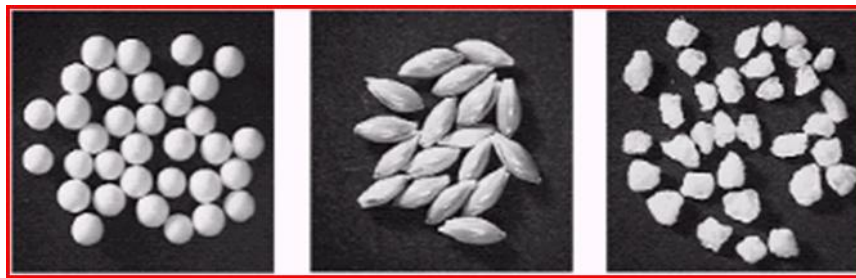
FIGURE 1.1 – Exemples de différentes formes de grains. A gauche, des billes de polyester (forme sphérique). Au centre des graines (forme allongée). A droite, des grains de sable (polyhèdres).
