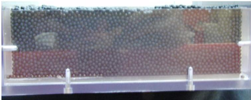
FIGURE 5.8 – Photo du pack de grains vue par la face avant de la boîte après préparation. Le milieu est préparé de telle façon que les grains puissent sortir de la boîte
