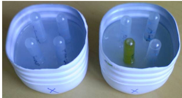
Figure III.7. Les deux fantômes utilisés pour le calibrage des données CT du rat.
