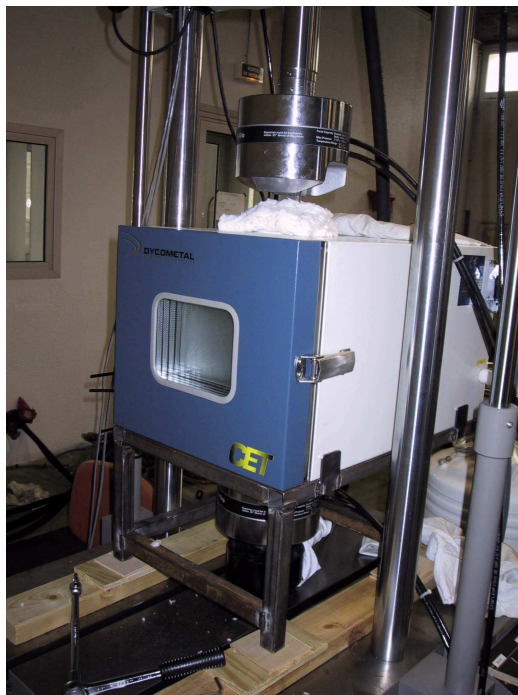
(c) Enceinte thermique CET (ESIM).
