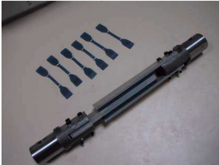
FIGURE III.1 – Éprouvettes de traction et de double cisaillement.
