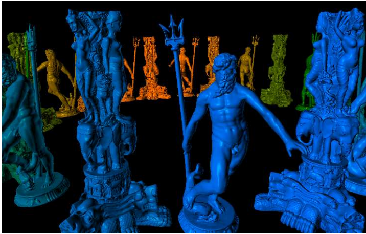
FIG. 4.14 – Sur une scène complexe composée de plusieurs objets, le rendu adaptatif permet d’augmenter la vitesse d’affichage de 15 à 20% en moyenne. Le nombre d’images par seconde passe de 12 à 15 en gros plan, de 25 à 32 en plan large pour une résolution de 1920 \times 1125 .
