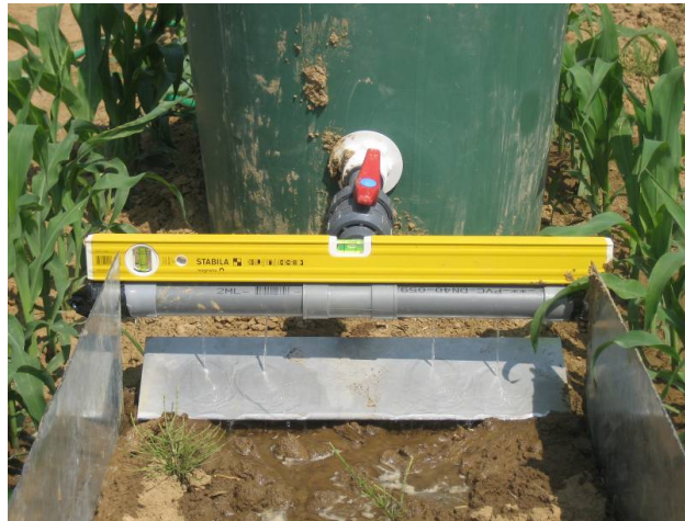
Figure 2.19 – Dispositif générant la lame d'eau ruisselée
