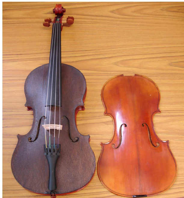
FIG. 4.13 – Violon fini dont la table d'harmonie d'origine en épicéa (à droite sur la photo) a été remplacée par une structure sandwich balsa/fibre de lin.
