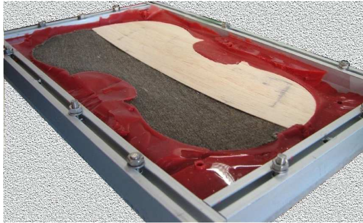
FIG. 4.12 – Conception de la table d'harmonie en matériau composite. Les couches de fibre de lin (en gris sur la photo) et l'âme en balsa (en blanc) sont empilées dans le moule en silicone de la table d'harmonie d'origine (le moule est formé de deux faces).
