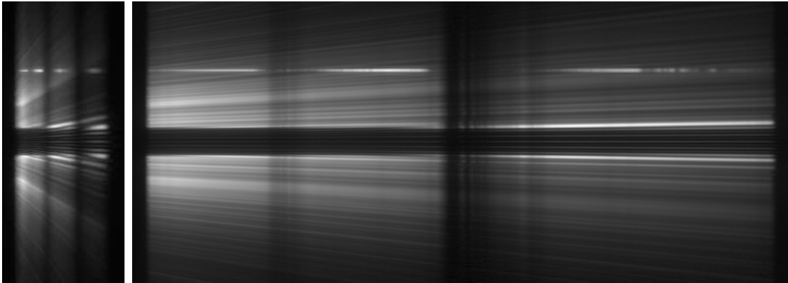
FIG. 4.1 – Exemple de spectres simulés en LRS (gauche) et MRS (droit) correspondant à une étoile M0 à 10 pc et une planète avec T_{eff} = 1000 K à une séparation angulaire de 1.0'' . Les speckles stellaires forment des lignes obliques dans l'image, alors que la planète forme une ligne horizontale brillante dans la partie supérieure de l'image. Les lignes sombres verticales correspondent à l'absorption atmosphérique terrestre. Le spectre LRS couvre une étendue spectrale de 0.95 à 2.3 \mu\text{m} , et le spectre MRS de 0.95 à 1.8 \mu\text{m} . Pour plus de clarté l'échelle de visualisation est une fonction de puissance 0.5 .
