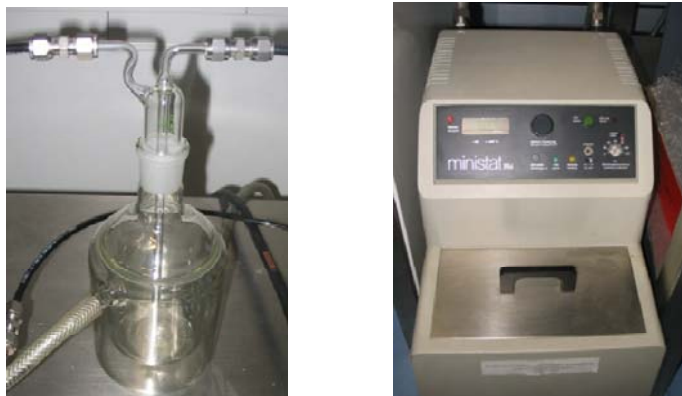
Figure 5 Barboteur avec double enveloppe contenant l'eau du bain et l'éthylène-glycol. Photo du bain thermostaté utilisé.
