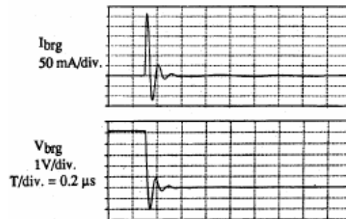
Figure 8. Mesure sur un moteur: la tension arbre - carcasse et des décharges dans les paliers [Chen 06a]
